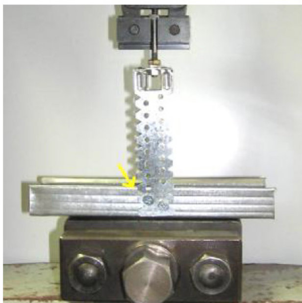
Fig 1 Informe antes de la prueba, la flecha indica la medida de cambio de posición
